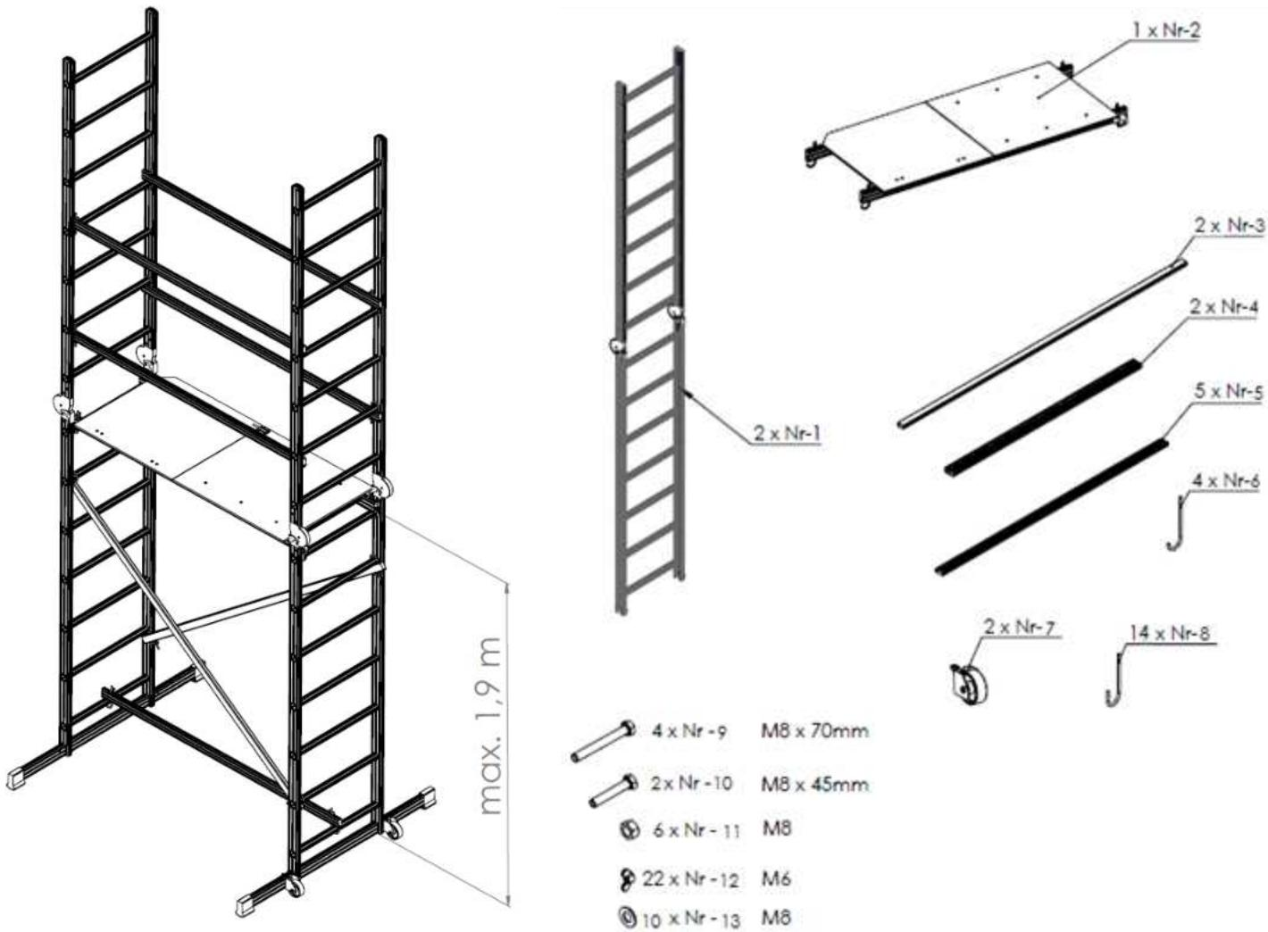
**TAB 1.** List of scaffolding parts / Wykaz części rusztowania / Seznam lešení / Liste der Gerüstteile / Lijst met steigeronderdelen / Liste des pièces d'échafaudage / Lista părților schelelor
